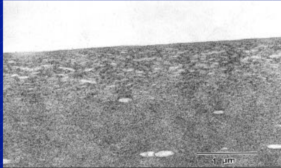
未処理のセロファンの断面
